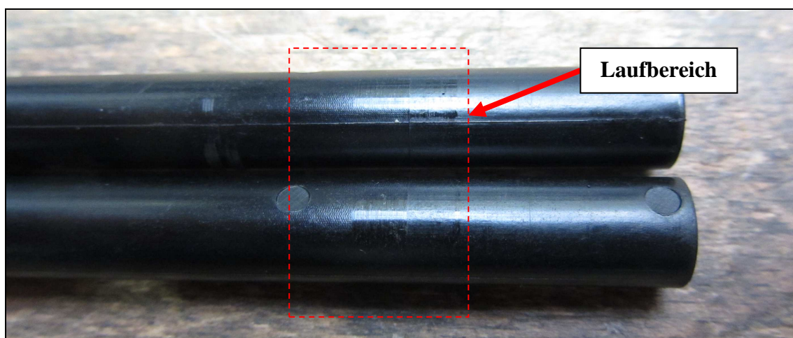
Abbildung 3: Verschleißbild der Wellen
